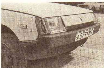
Передняя часть автомобиля: изменены облицовка, фары, установлены дополнительные указатели поворота на крыльях.
